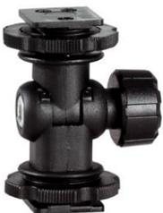
Das Videoleuchten-Modell CN-B150 verfügt über einen abnehmbaren Fuß. Zum Abnehmen des Fußes die obere Rändelschraube im Uhrzeigersinn drehen. Anschließend kann der Fuß aus dem Zubehörschuh der Videoleuchte herausgezogen werden. Zum Fixieren des Fußes Rändelschraube entgegen dem Uhrzeigersinn drehen, bis der Fuß fest sitzt. Der Fuß kann über eine seitliche Schraube in der Neigung verstellt werden.
