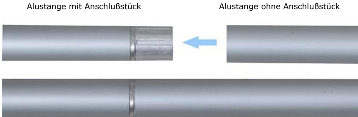
**2.** Nachdem alle Stangen zusammengefügt worden sind, bauen Sie mit Hilfe der **Eck-Verbinder** die Stangen zum fertigen Gerüst des Lichtzeltes zusammen.
